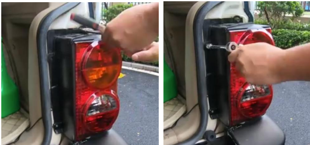
图 2.9 安装新大灯总成
