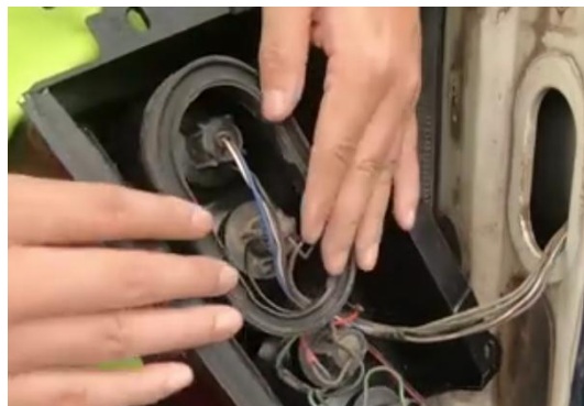
图 2.8 套上新防水胶圈
