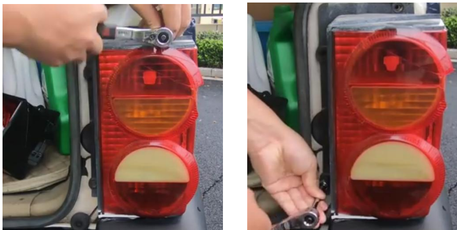
图 2.3 拆卸尾灯螺栓
