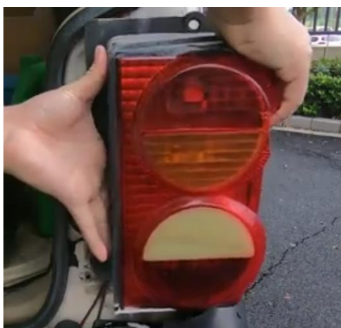
图 2.4 取出右后尾灯总成
