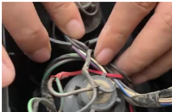
图 2.7 安装尾灯线束
